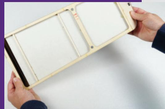
**Schritt 3:** Damit der Cockpitboden sich nicht aufschwingen kann, sollten vorne am Boden und unter der Pilotenfigur 5-mm-Balsaleisten angebracht werden.
