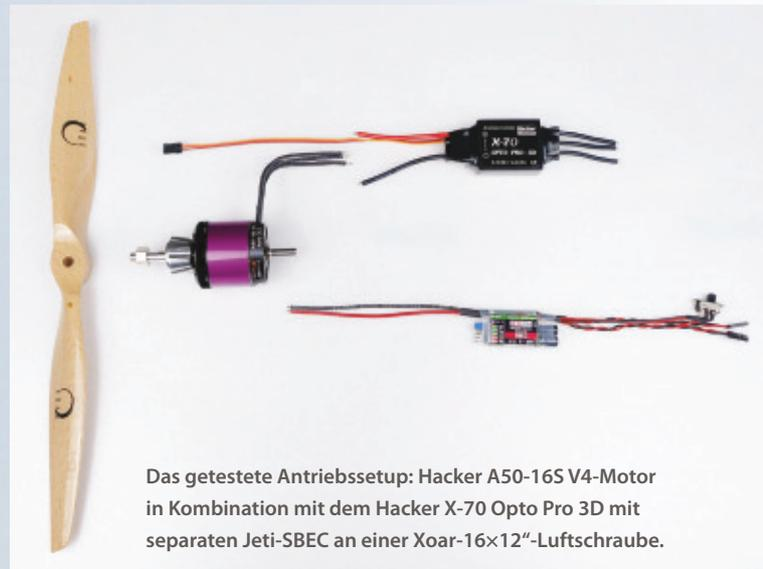
Das getestete Antriebssetup: Hacker A50-16S V4-Motor in Kombination mit dem Hacker X-70 Opto Pro 3D mit separaten Jeti-SBEC an einer Xoar-16x12"-Luftschaube.
