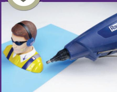
**Schritt 2:** Die Naruke Hobby-Pilotenfigur mit Heißkleber an den Cockpitboden kleben. Danach kann man den Cockpitausbau von vorne in die Kabinenhaube hineinschieben und diesen mit Heißkleber an der Kabinenhaube fixieren.
